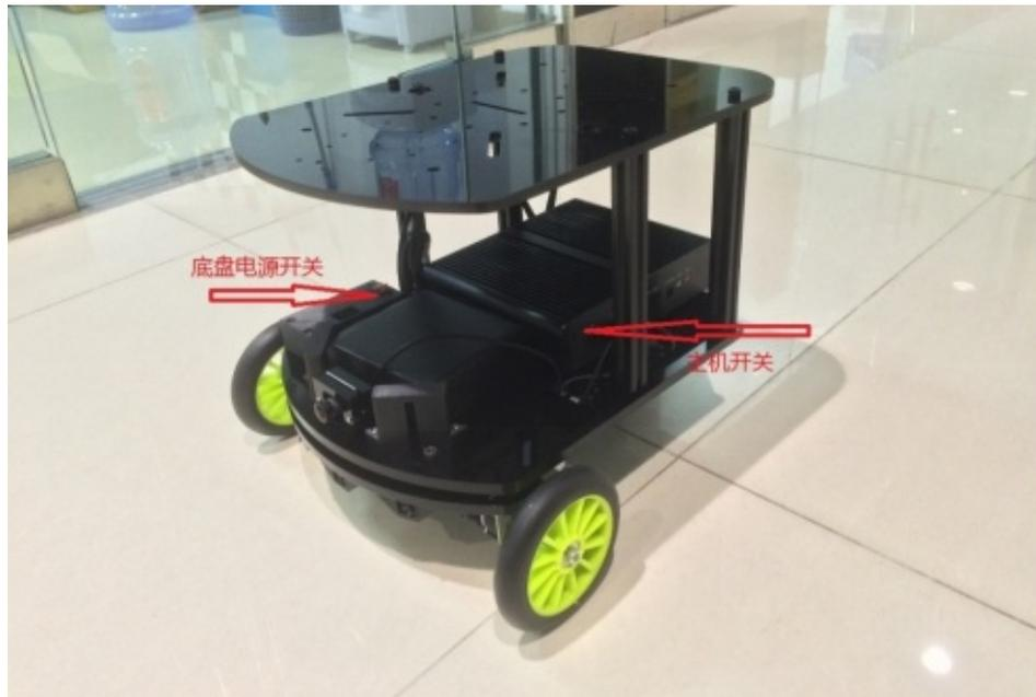
将电池平放在主机前方空余区域（电池靠两个小黑块堵住），根据线标提示接上底盘电源线，安装好电脑主机wifi天线，摄像头和底层USB连接模块连接上主机的USB接口即可。
