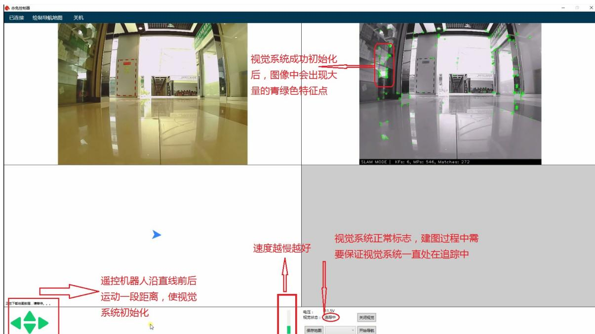
现在视觉系统已经启动完成、开始遥控机器人在运动区域移动，遥控过程中尽量避免纯转动（只按左转或右转，这容易使视觉系统丢失目标），请按住前进键的同时按左转或右转键，使机器人沿大半径轨迹转弯。
