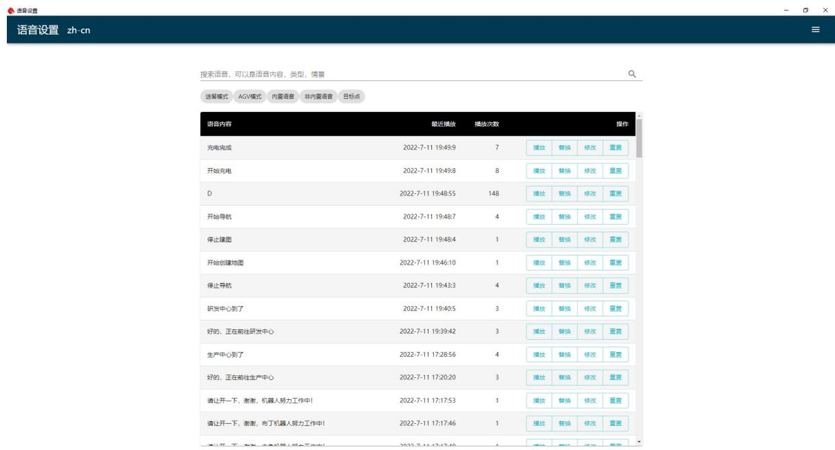
APP上的语音在机器人上播放过之后, 上图的列表中就会新增一个APP播放的语音条目。如果想要使用自定义的音频文件可以点击这个条目的替换按钮。注意替换的音频格式只能是wav或则MP3, 推荐使用wav格式。
