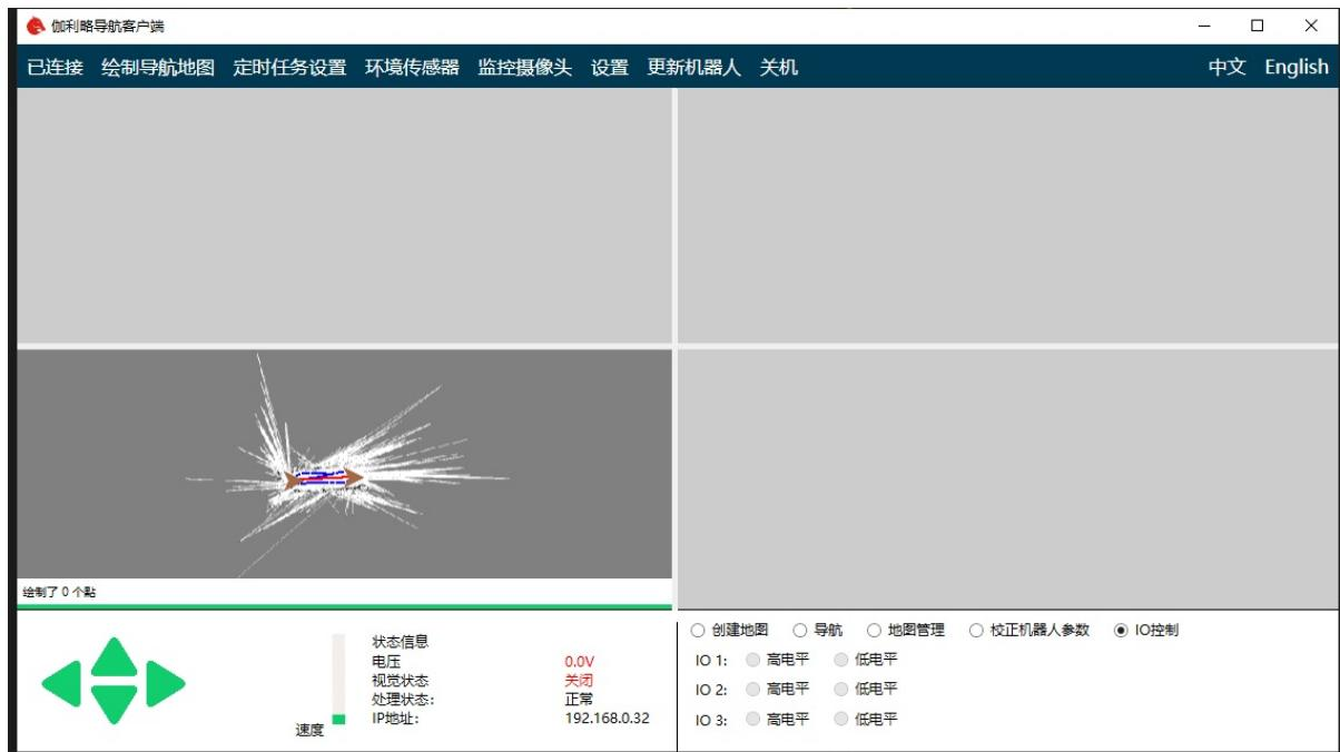
可以看到有三个IO，同时标有高电平和低电平两个选项。
