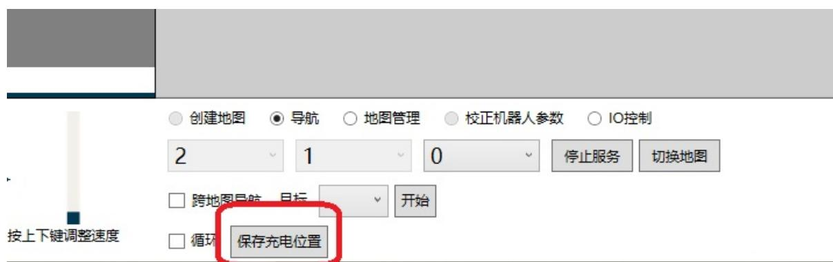
此时客户端上显示的地图会增加充电桩位置标志。注意导航系统需要完成初始化后,才能保存充电桩位置。
