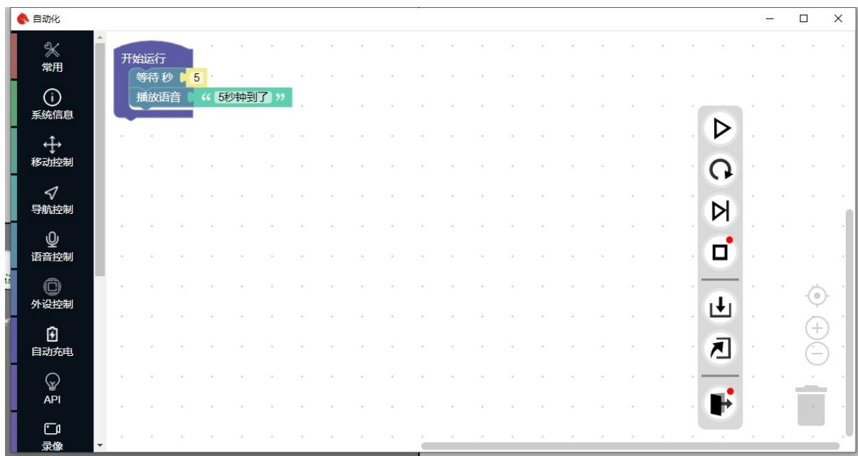
下面我们就可以直接复制上面的组件然后放置在其后面。可以用右键也可以直接通过Ctrl + C, Ctrl + V进行复制。
