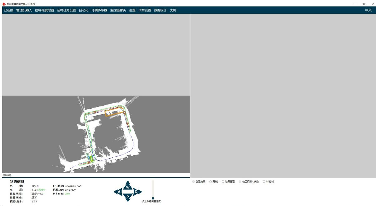
底盘运动控制 支持键盘 操纵，操作风格类似极品飞车游戏。WSAD控制上下左右，上下箭头控制速度档位。
