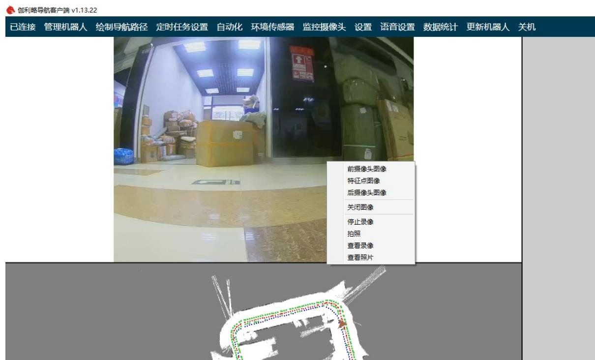
注意：只要没有手动选择停止录制，机器人就会一直录制视频。即使关闭了此图像，甚至关闭客户端视频录制也不会停止。录制视频程序会保证机器人至少有5G的剩余硬盘空间。当空间不足时，机器人会自动删除旧视频释放空间。只保留最近的视频。
