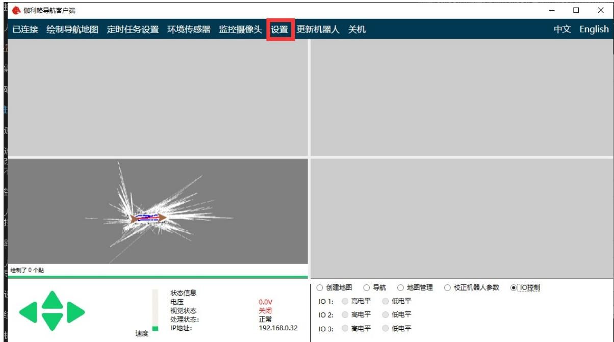
如果导航栏并没有设置按钮则说明机器人不支持设置参数。可以在更新机器人程序后再次尝试。
