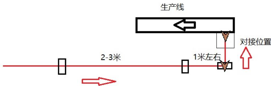
在目标点设置方面，首先在对接点之前的位置设置一个目标点。设置时可以使用对齐到二维码按钮，保证这个目标点在二维码上。也可以遥控机器人到二维码上，然后使用对齐到当前位置选项。注意这个目标点的角度要和最终对接位置的角度一样，这样机器人就移动到最终对接位置就不需要额外的旋转。对接点前的目标点设置完成后遥控机器人到最终的对接位置上，然后在最终对接位置添加一个目标点。注意要在开启导航的情况下，根据机器人当前位置添加这个点。保证移动到这个目标点之前机器人扫到了对接位置前的二维码，并且没有扫到其他的二维码。
