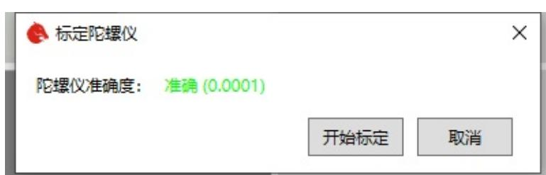
弹出标定陀螺仪窗口。此时窗口中会显示陀螺仪数据。此数值越小则说明机器人陀螺仪越准确。
