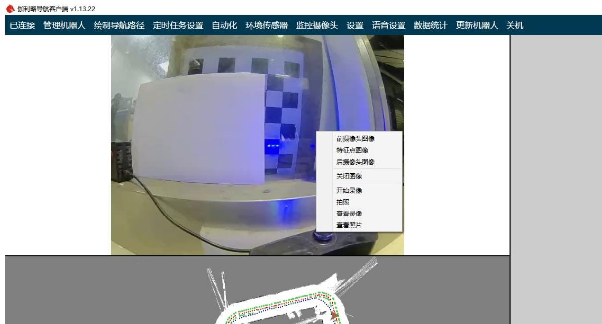
选择开始录像后，机器人就会自动将现在打开的视频录制保存在机器人上。
