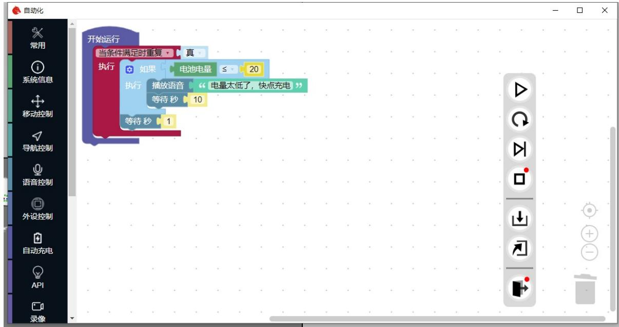
上面的例子中，我们让机器人不断的判断电量是否小于20%，如果小于20%就播放电量低的语音。注意其中的延时组件，如果在循环中没有延时，那么机器人会不断的执行循环，这样会导致机器人的CPU占用率非常高，所以我们需要在循环中加入延时，这样机器人就会在每次循环结束后等待一段时间再进行下一次循环。
