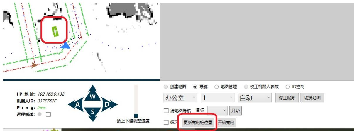
保存完成后，点击停止导航。在绘制路径界面中添加到充电桩位置的路径。
