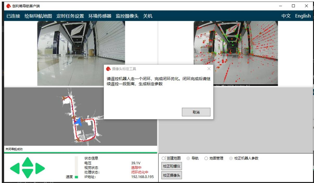
等待闭环完成，形成闭环后继续遥控机器人前进一段距离。此时机器人会自动计算出标定参数，和误差。
