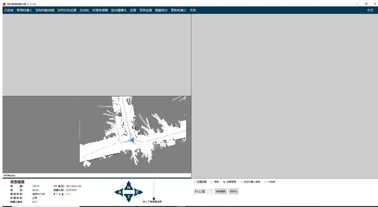
开启更新之后可能机器人无法追踪。这时候可以遥控机器人到环境变化不大的地方，使得机器人可以追踪环境。如果机器人仍然无法初始化，可以参照上面的手动初始化方法完成初始化。之后的操作和建图的过程一样。当更新完成后，首先点击另存为。然后输入新地图的名称等待保存完成。如果觉得新地图的质量不错，那么可以点击结束更新，停止地图更新程序。在地图下拉菜单中可以看到新更新的地图。之后就可以用新地图去导航了。
