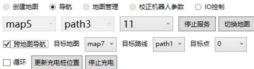
选择好对应的地图，导航路径和目标点，点击开始机器人就会自动导航到目标点了
