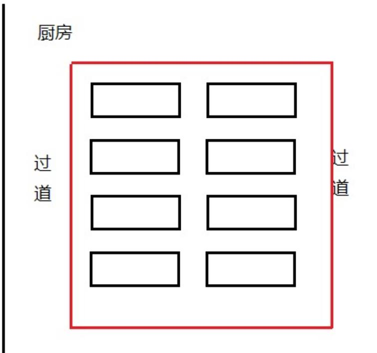
两侧为过道，中间是桌子。我们可以遥控机器人按照红色路线首先顺时针转一圈。在客户端提示闭环优化完成之后再逆时针转一圈（如果机器人是双摄像头建图模式，可以直接后退再转一圈，不用掉头），同样也需要闭环优化完成（双摄像头建图模式第二圈可以不用闭环）。这样就能获取到比较好的建图效果。
