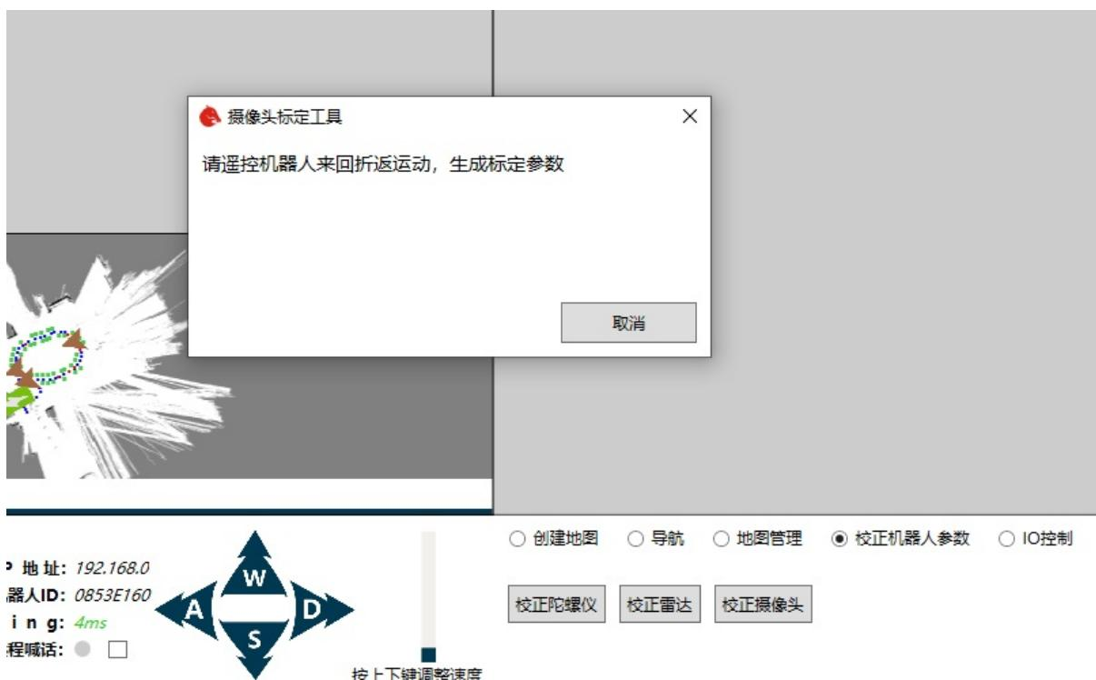
按照窗口提示，移动机器人前进三、四米远然后再掉头回来，完成折返运动。移动过程中机器人会自动计算出标定参数，和误差。
