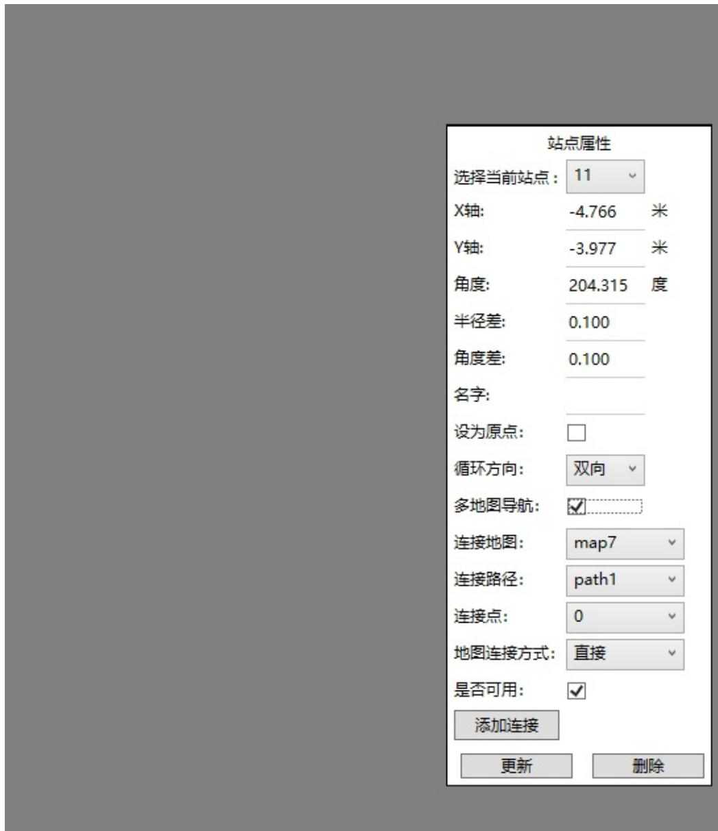
连接地图，连接路径，连接点就是之前记下的地图，路径，导航点信息。
