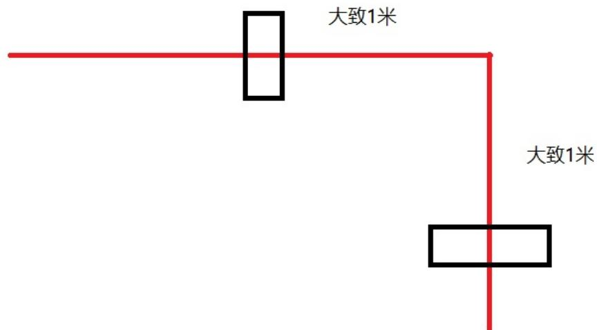
图中红线是机器人需要运动的路径，两个方形的框为二维码。对于长条形二维码注意要把二维码长的一边垂直于机器人运行路径。二维码不要贴在拐点，而是贴在拐点的前面和后面1米左右处。这样机器人在入弯和出弯的时候都能识别到二维码。
