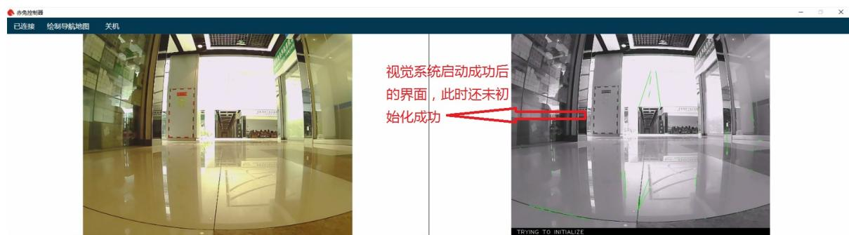
遥控机器人向前直线运动，直到视觉系统初始化成功，激光雷达和混合模式建图没有初始化过程可以跳过
