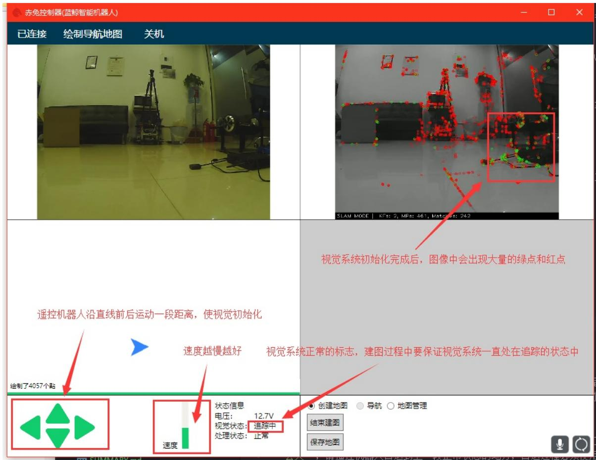
现在建图系统已经启动完成、开始遥控机器人在运动区域移动，遥控过程中尽量避免纯转动，只按左转或右转建图精度更差（建图模式下系统默认禁用了原地旋转，结束建图会自动解锁原地旋转），请按住前进键的同时按左转或右转键，使机器人沿大半径轨迹转弯。
