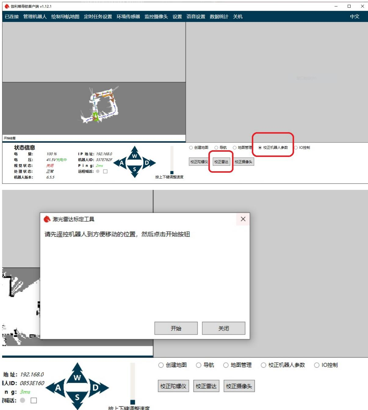
根据提示, 遥控机器人到较开阔的位置。然后点击开始按钮。
