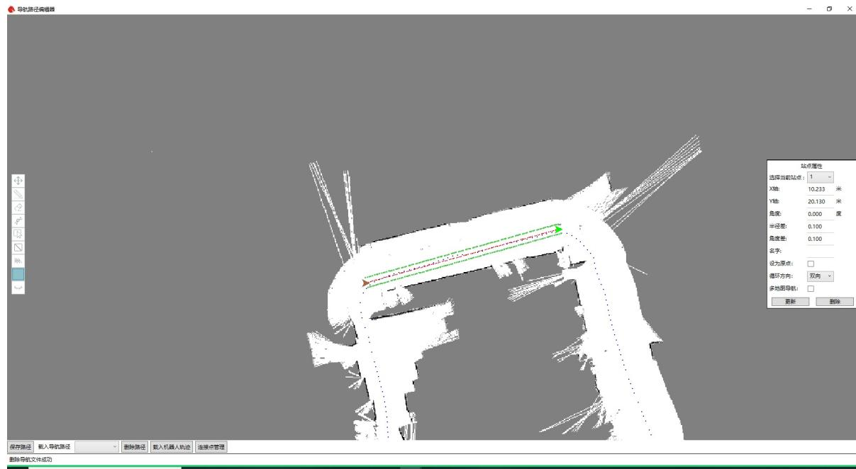
在下方的当前选中的导航点中输入对应的目标点序号，对应的目标点会在图中显示绿色。通过这种方式我们可以知道每个目标点的序号。注意在送餐机器人模式中0号点对应着后厨位置。
