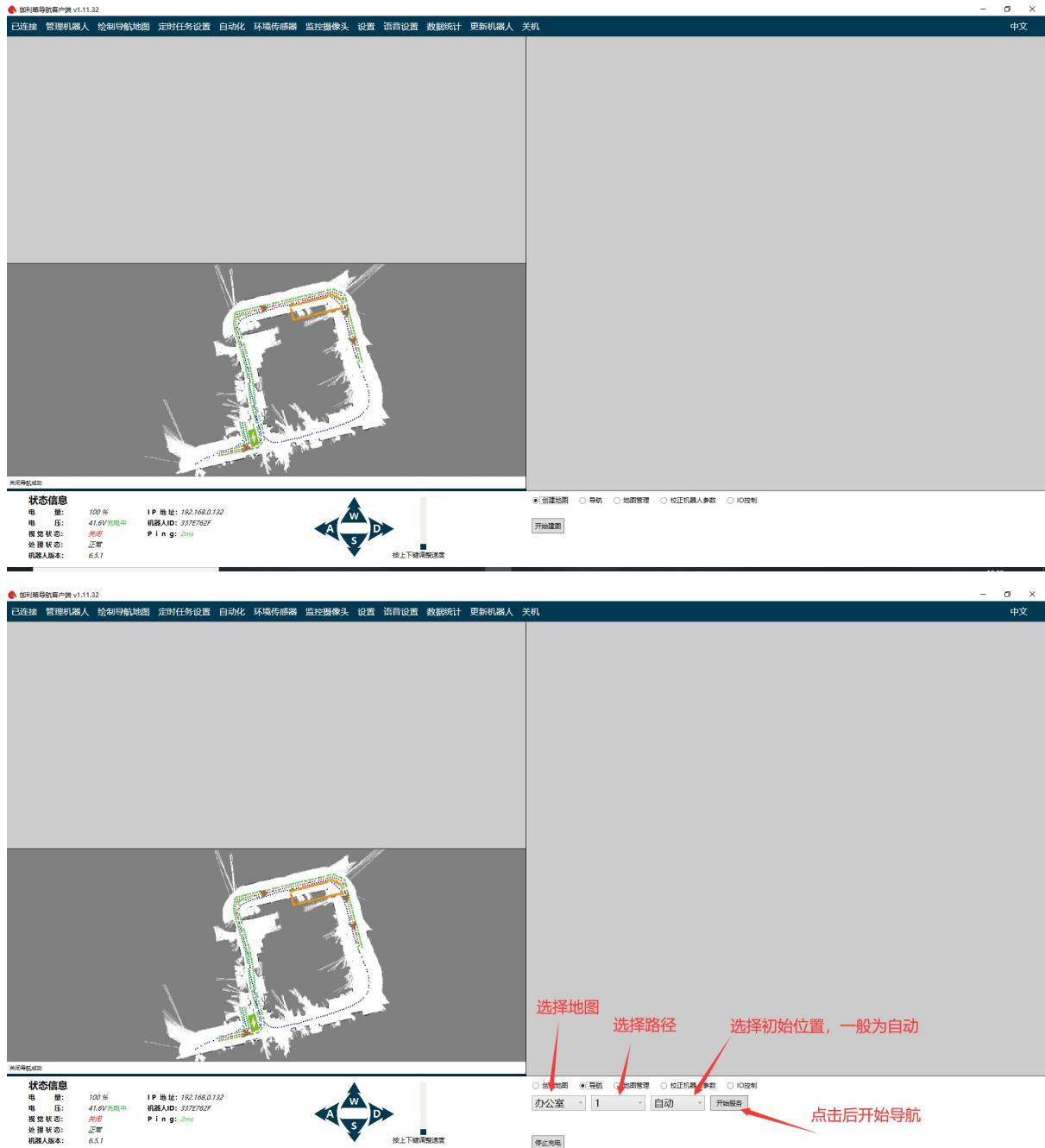
将机器人遥控到能够追踪的位置，机器人必须在导航路线上，且机器人朝向必须和建图时的朝向一致。
