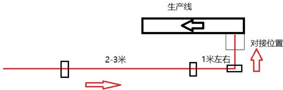
如上图所示的对接过程。其中红色直线为机器人实际行走的路线。黑色的粗线框是生产线。黑色的细线框是机器人的最终对接位置。具体的二维码贴法可以参照上图。机器人导航的时候会先移动到对接位置前面的二维码位置。然后再通过自动化功能局部移动到最终位置。这样就可以保证最终对接位置的准确性。
