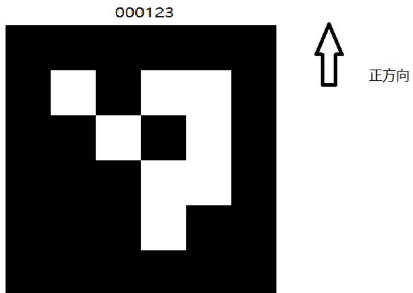
对于需要精准对接的位置，不要在最终的对接位置贴二维码。因为机器人扫描到二维码的时候会进行位置修正，此时机器人可能会小范围旋转和移动。如果在最终位置贴二维码，机器人会在最终位置进行位置修正，而大部分情况下最终位置是禁止旋转和移动的。比如需要对接生产线，如果最终位置旋转极有可能会撞到生产线。在最终位置的前面贴二维码，这样机器人就会在最终位置前面进行位置修正。
