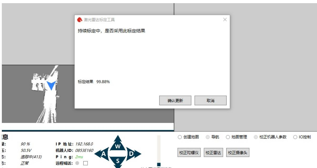
如果结果达到99%以上，同时机器人是在直行路段（转弯路段标定结果比较差）。满足这两个条件，你可以选择接受结果，点击确认更新按钮即可。
