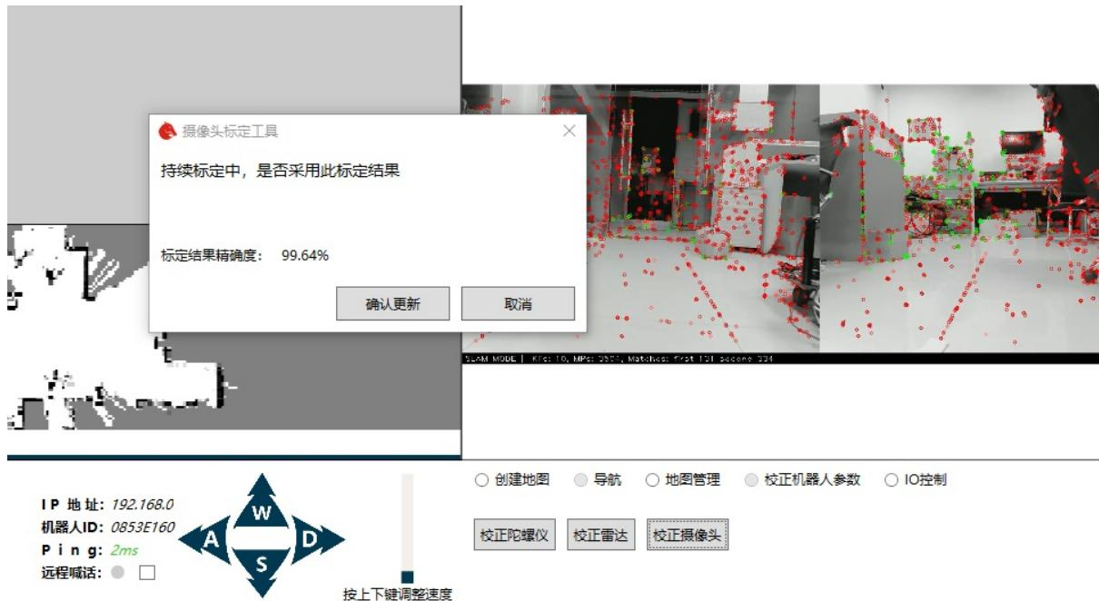
如果结果达到99%以上，同时机器人是在直行路段（转弯路段标定结果比较差），以及机器人至少完成了一次掉头折返运动。满足这三个条件，你可以选择接受结果，点击确认更新按钮即可。
