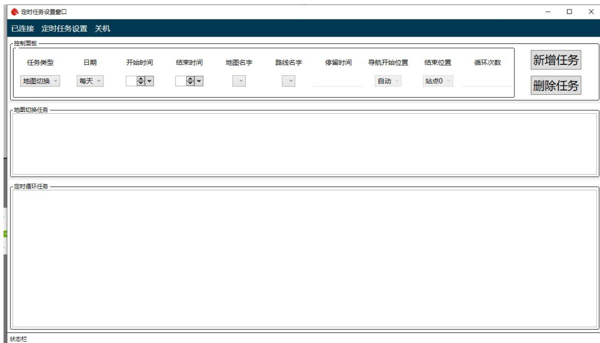
定时任务分为地图切换任务和定时循环任务两种。地图切换任务只是在特定时间把当前导航地图和路径切换到目标导航地图和路径，但是并不实际执行导航任务。定时循环任务则是在特定时间执行导航任务。
