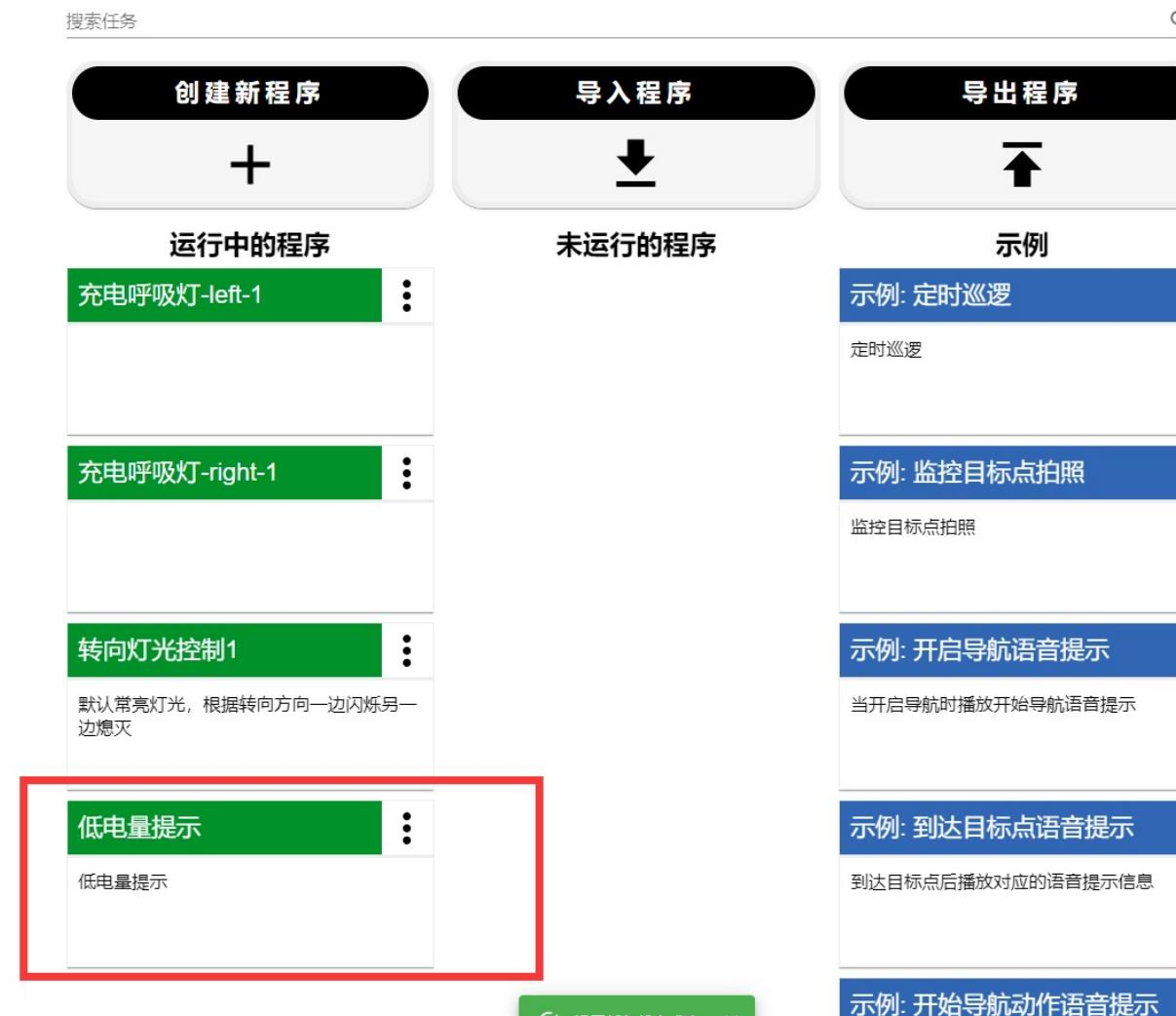
同样停止程序也可以点击正在运行的程序的右上角的三个点。然后选择停止程序。
